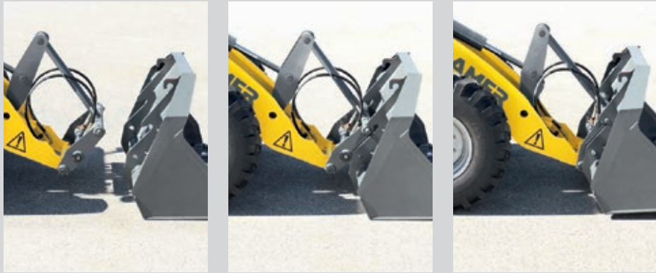
Byt på en sekund tack vare seriekopplade hydrauliska snabbväxlare.
