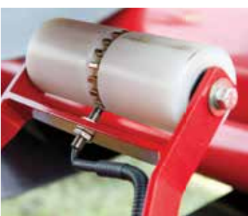
En kontinuerlig överlappning under balrotationen övervakas av sensorrullen.
