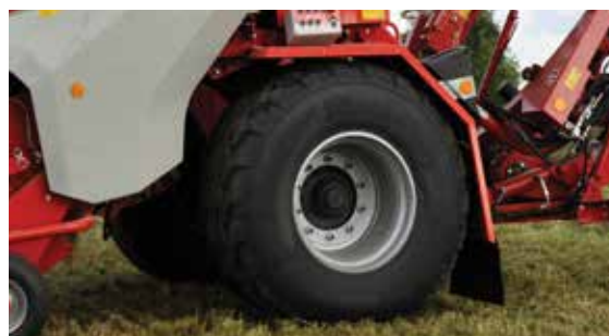
De stora däckerna säkerställer ett minimum av markpackning/skador och ger även bra stabilitet både på fältet och under transport på väg.
