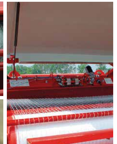
BÖJD SPRIDNING Det böjda spridningsröret sträcker nätmaterialiet ända fram till, och runt, kanterna på balen.
