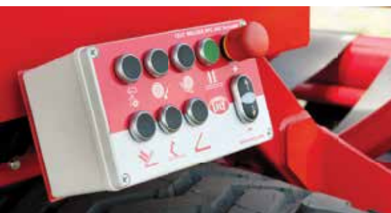
En enkel manuell kontrollbox monterad på sidan av maskinen.
